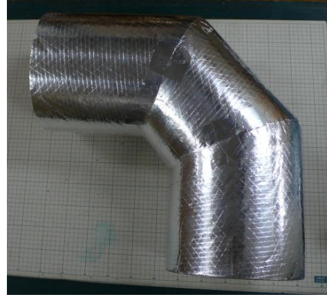
内径 200φ (外径 250φ) ダクト 90° エルボの製作方法
