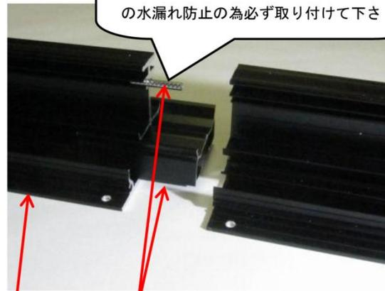
スプリングピンはアルミ棧同士の上下・左右のズレ止め、ジョイント樋は連結部の水漏れ防止の為必ず取り付けて下さ
